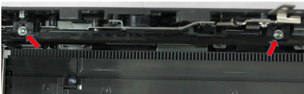
第三步：将固定锁的螺丝拆下，即图中红色箭头指向的螺丝。将锁整体取下。
