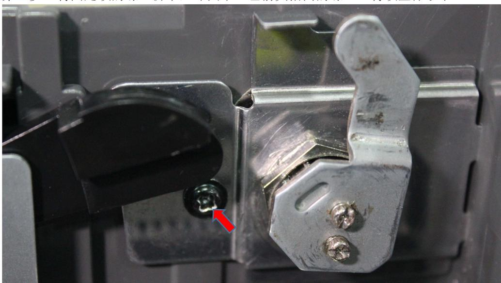
第三步：将卡封加钞箱锁头插入箱体锁孔，将卡扣从箱内扣上。注意安装方向。
